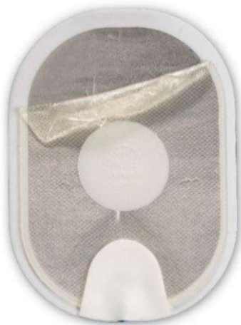
Abbildung 1: Abgelöstes Gel, das sich beim Abziehen übereinander gefaltet hat.
